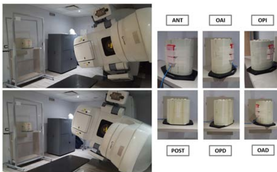
Fig. 6. Determinación de la dosis absoluta en condiciones de tratamiento. A la izq: uso del campo-dual (2 angulaciones de gantry) y a la der: las 6 posiciones del fantoma CIRS (a la derecha)
