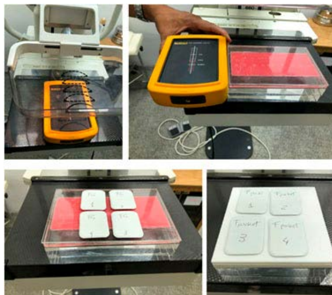
Fig. 5. Dosímetros patrón e irradiación de films dosimétricos para curva de densidades ópticas.
