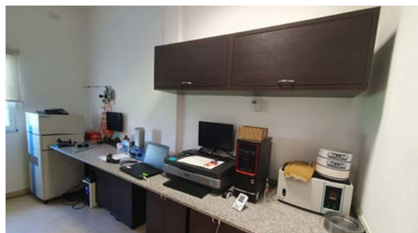
Laboratorio de Verificación Postal de Dosis (VPD). Lector automático Fimel PCL3 de dosímetros termoluminiscentes de LiF y accesorios.
