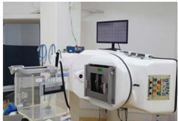
Sala de calibración de instrumentos dosimétricos nivel radioterapia. Irradiador de ^{60}\text{Co} Teradi 800 (INVAP), banco de calibración, fantoma de agua y accesorios.
