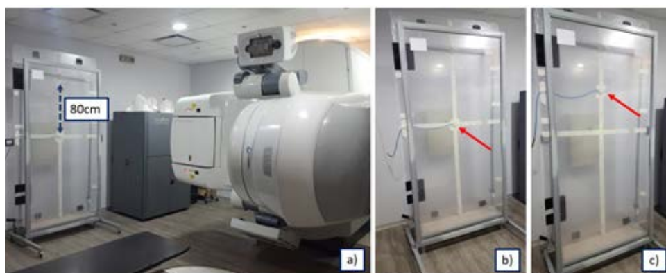
Fig. 4. Medición del hemihaz con gantry a 90 grados, a) Disposición general, b) Cámara sobre el eje, c) Cámara desplazada a 40 cm sobre el eje vertical.
