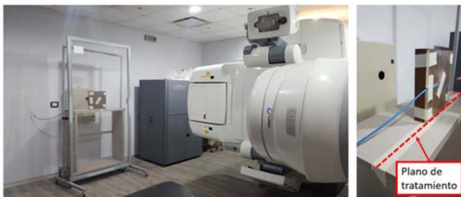
Fig. 5. Determinación de la energía en condiciones de tratamiento (Izq: Disposición general, Der: Ubicación de la superficie del fantoma sobre el plano de tratamiento)
