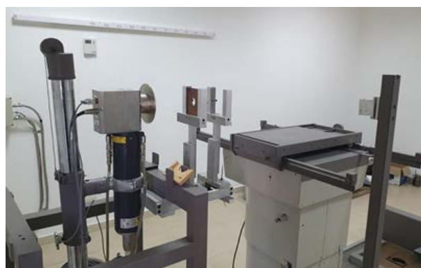
Irradiador Ital Structures MAM 2006 utilizado para la calibración de instrumentos dosimétricos empleados en mamografía
