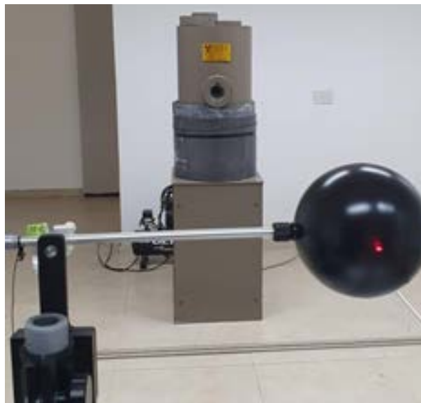
Equipamiento utilizado para las calibraciones nivel radioprotección. Irradiador de ^{137}\text{Cs} , ^{60}\text{Co} Hopewell Designs G-10-2-2600 y cámara de ionización esférica PTW TN32002.
