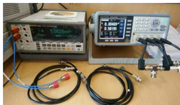
Equipos utilizados para la calibración de electrómetros. Multímetro Fluke 8846A y Capacímetro LCR-6300.
