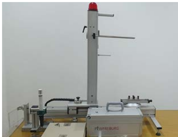
Irradiador beta patrón secundario BSS-2 para la calibración de dosímetros en energías beta. Irradiador y accesorios.
